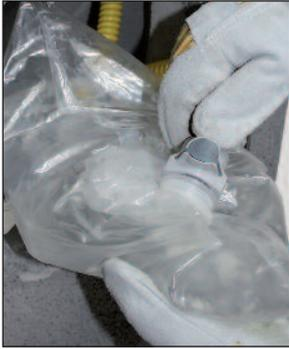
Bei fehlender Ableitung kann Kondensat- und Niederschlagswasser mit dem PARAT-Kondensatauffangbeutel, mit spezieller Sicherheitskupplung zum Beutelwechsel, gesammelt und entsorgt werden.
